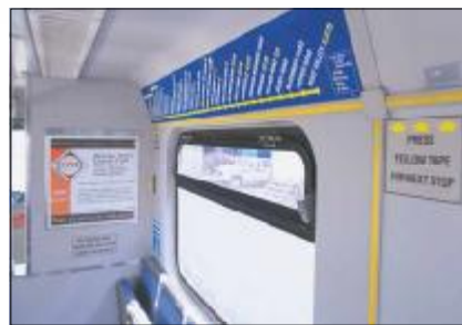
La mousse acrylique 3M VHB colle le panneau au châssis en une seule opération et améliore l'esthétique du graphisme
